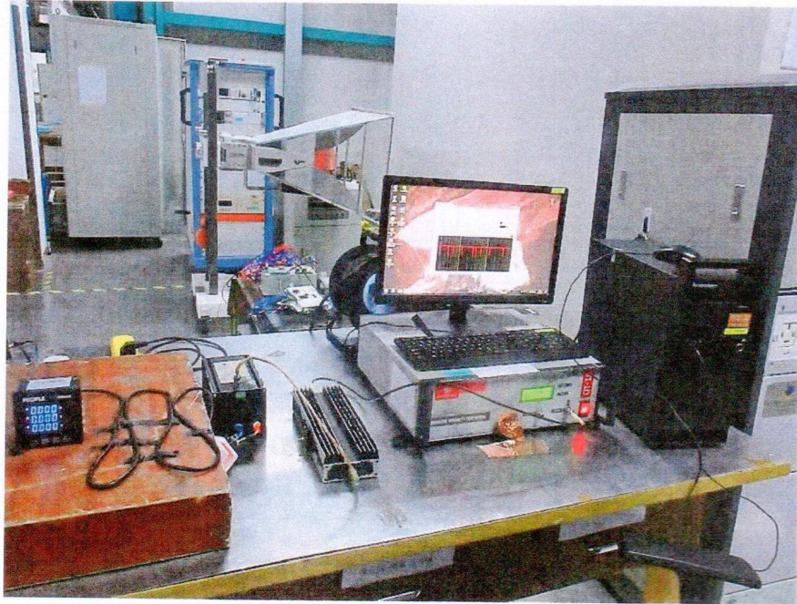
射频场感应的传导骚扰抗扰度试验布置图
