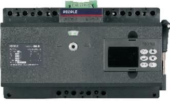
RDQH5Y双电源自动转换开关（以下简称双电源），它适用于交流50Hz、额定工作电压400V、额定工作电流50A至125A的供电系统。可根据需求或具体电路情况进行两路电源之间的切换选择。本产品具有过载、短路、过电压、欠电压保护功能，同时还具备消防、双分和输出合闸信号功能。产品适用于高层楼宇、商场、银行、医疗卫生等不允许停电的重要场所。产品符合：GB/T14048.11标准。
