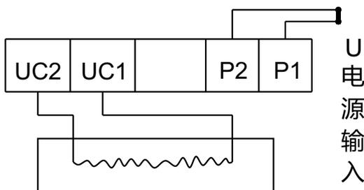
**警告：欠电压脱扣器必须先通电，断路器才能再扣及合闸，否则将损坏断路器！**
