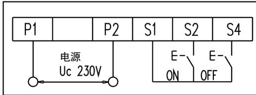
电压规格: AC50Hz 100 ~ 240V
