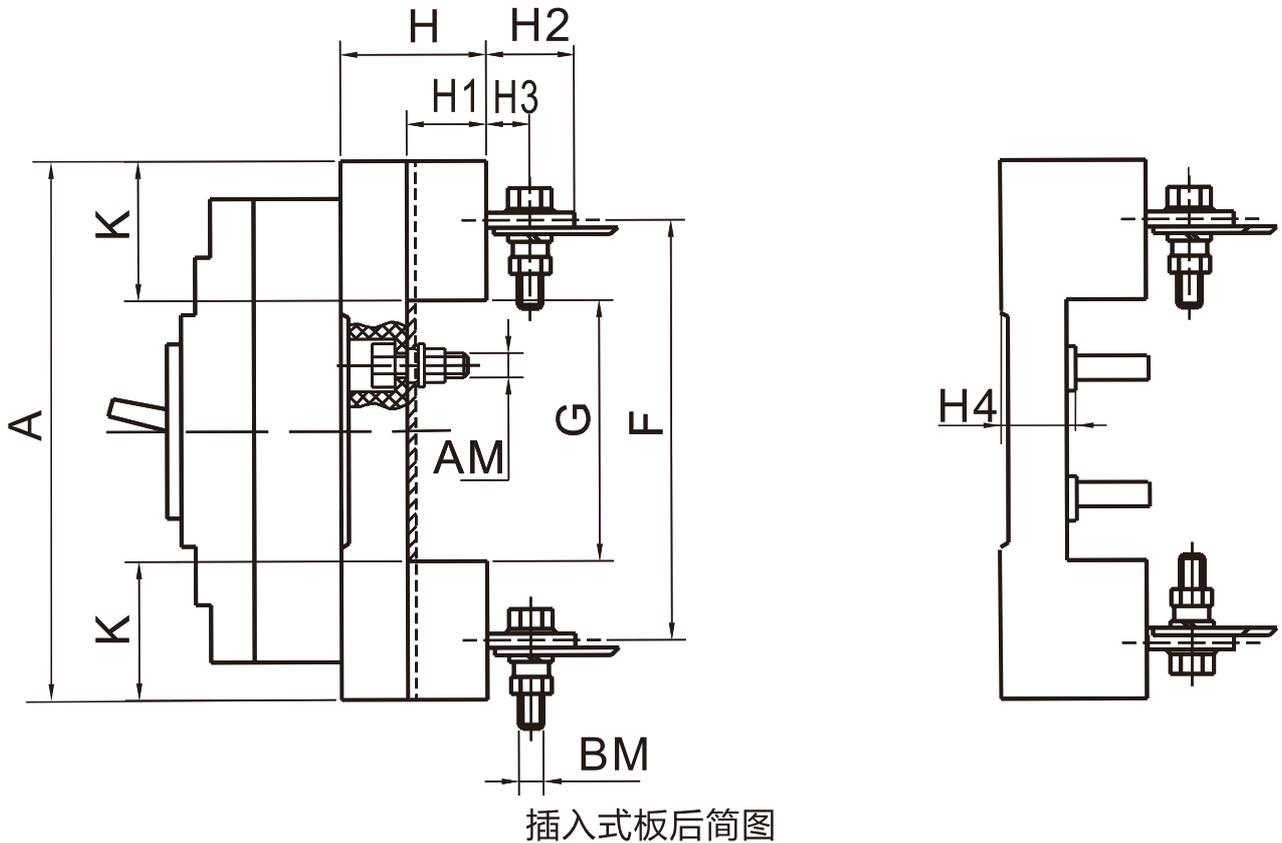
图11 插入式板后外形尺寸(单位:mm)
