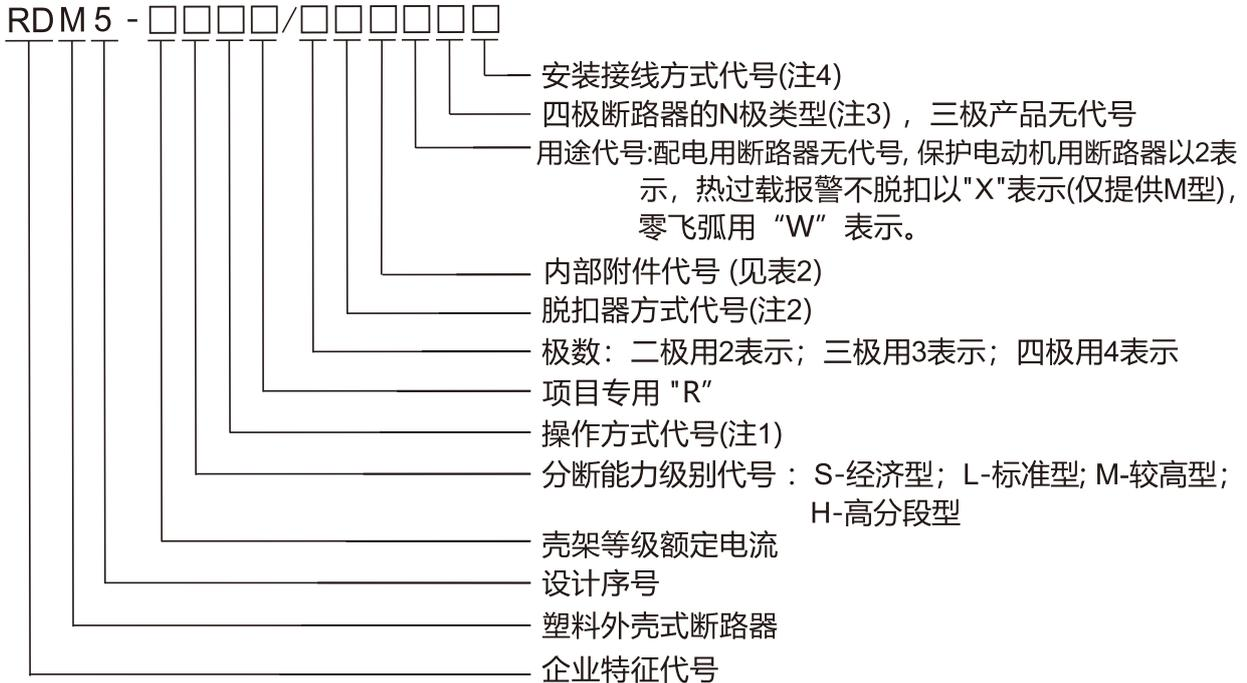
注1:手柄直接操作无代号；电动操作用P表示；转动手柄用Z表示；
