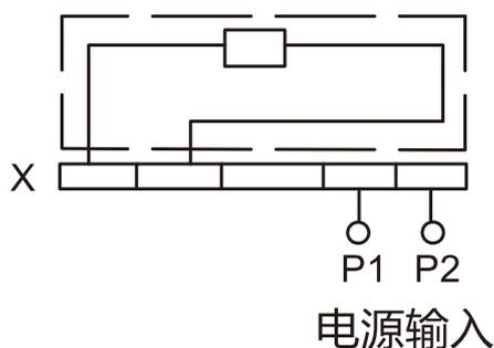
警告：欠电压脱扣器必须先通电，断路器才能再扣及合闸，否则将损坏断路器！
