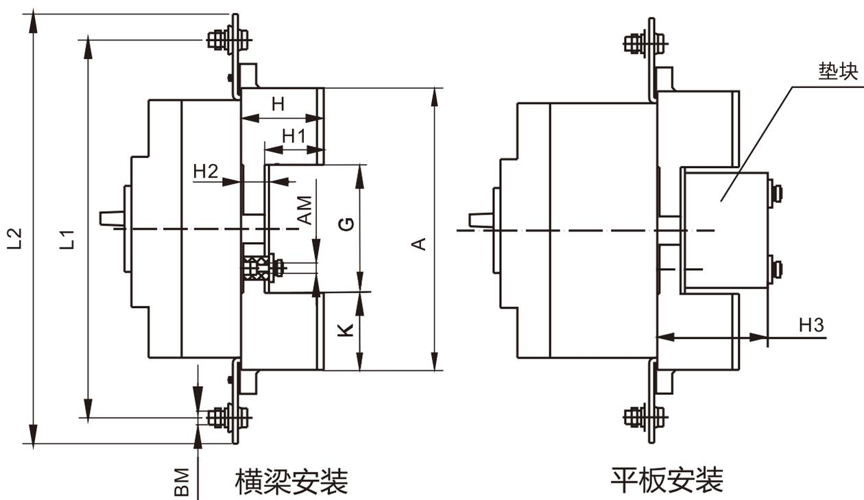
图9 插入式板前外形尺寸(单位:mm)
