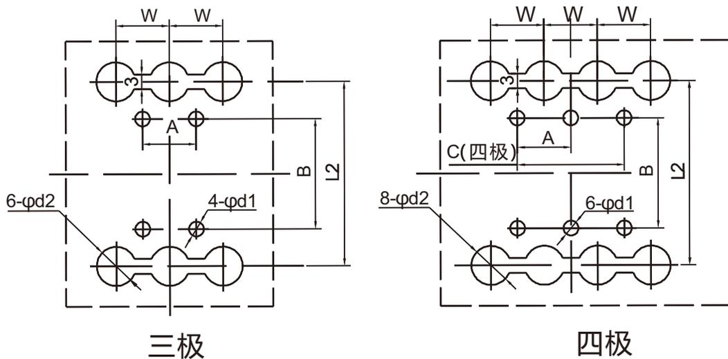
图8 RDHM5系列板后接线安装板开孔尺寸
