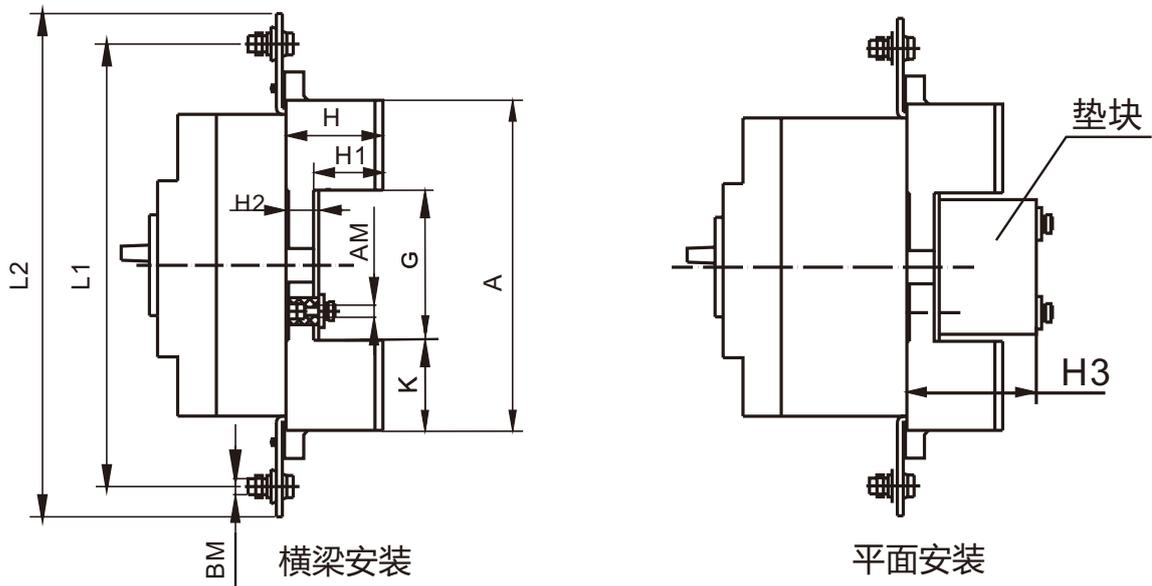
图9 插入式板前外形尺寸(单位:mm)
