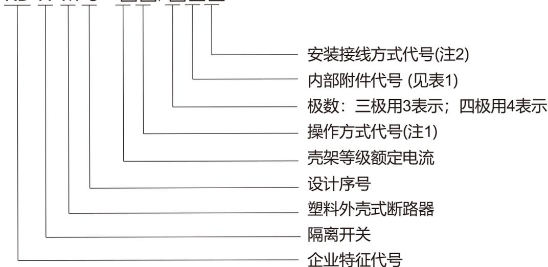
注1：手柄直接操作无代号；电动操作用P表示；转动手柄用Z表示；
