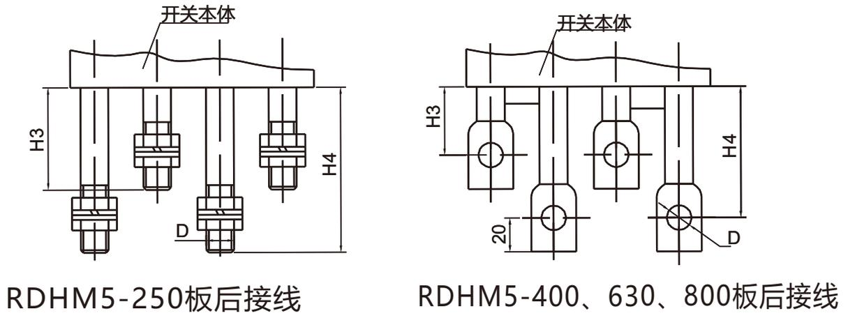
图7 RDHM5系列板后接线外形及安装尺寸
