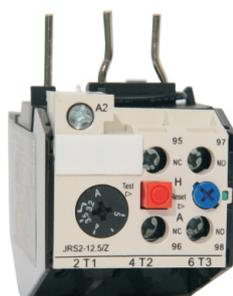
JRS2系列热过载继电器适用于交流50Hz/60Hz。额定工作电压 $U_e$ :690V, 电流0.1~630(A)的电力系统中作交流电动机或线路的过载及断相保护。热继电器具有断路保护、温度补偿、手动复位和自动复位任意选择、动作灵活性检查、手动断开常闭触头及常开触头闭合的功能。产品符合: GB/T 14048.4、IEC60947-4-1 等标准。
