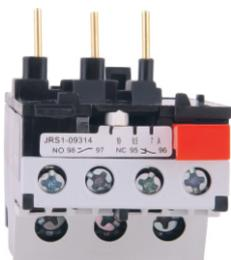
JRS1系列热过载继电器在交流50-60Hz。额定工作电压 $U_e$ : 380V, 额定电流0.10-80A的电路中, 作交流电动机的过载及断相保护用。
