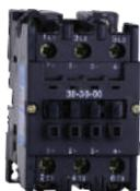
CJX8系列交流接触器主要适用于交流50Hz(或60Hz), 额定工作电压至690V, 额定工作电流至370A的电路系统中, 供远距离接通和分断电路或频繁地启动和控制交流电动机, 并可与JRS8系列热过载继电器组成电磁起动器以保护电动机可能发生的过载电路。
