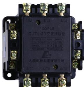
CJT1系列交流接触器适用于交流50Hz（或60Hz），额定电压至380V、电流至150A的电力线路中，主要用于远距离频繁接通和分断电路，并与适当的热继电器或电子保护装置组合成电动机起动器，以保护可能发生过载的电路。
