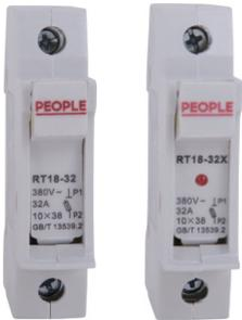
RT18系列有填料封闭管式圆筒形帽熔断器适用于交流50Hz,额定电压380V,额定电流至125A的工业电气配电装置中,作线路过载和短路保护之用。
