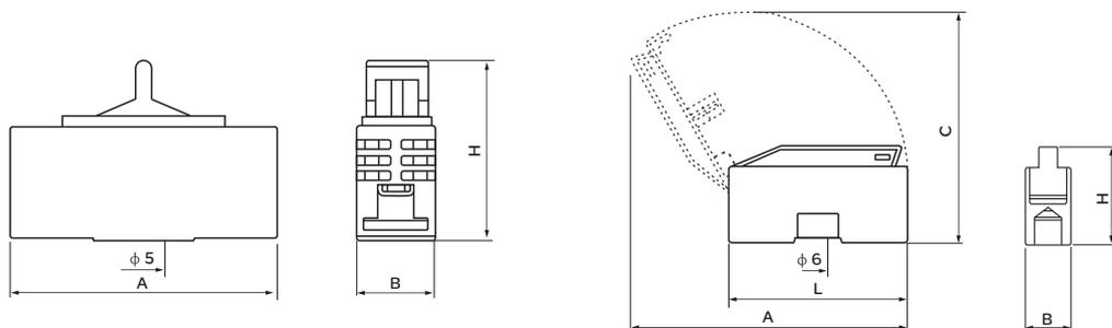
a.RT14-20熔断器支持件外形安装尺寸
